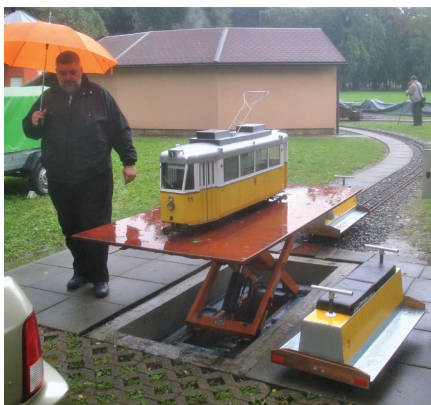
Hidravlična nakladalna miza za dovoz in odpremo vrtnih vozil z nosilnostjo 1000 kg. Naprava omogoča preprosto raztovarjanje neposredno iz avta.
